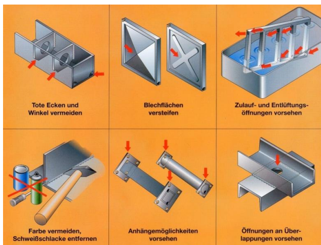
Abb. 54: Feuerverzinkungsgerechtes Konstruieren
