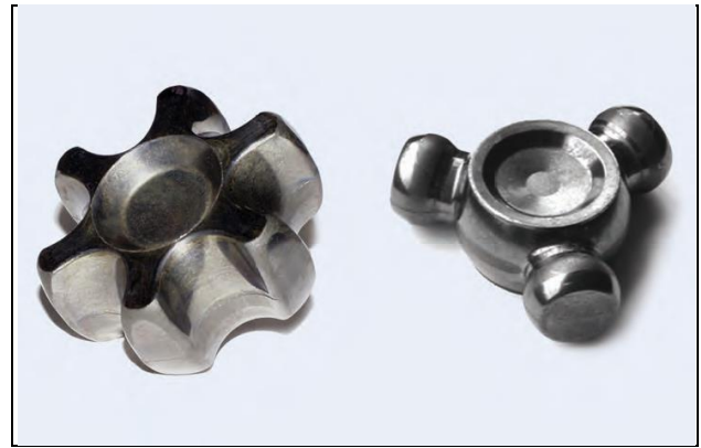
Abb. 119: Kugelnabe und Trisphär, hergestellt in geschlossenen Werkzeugen als Beispiele für lau warm umgeformte Bauteile
