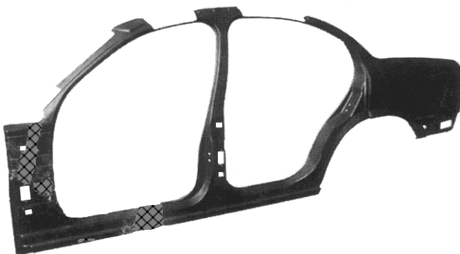
Abb. 146: Seitenwand der ULSAB-Karosserie
