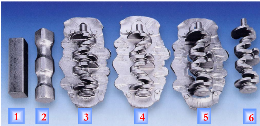
Abb. 170: Umformstufen bei einer 4-Zylinder-PKW-Kurbelwelle: 1: Zuschnitt, 2: vorgewalztes (Reckwalzen), 3: vorgeschmiedetes - 4: fertiggeschmiedetes -, 5: entgratetes - und 6: kalibriertes Werkstück
