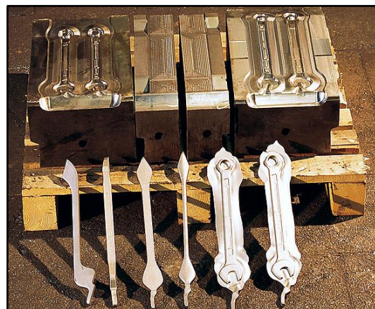
Abb. 175: Schmieden vom Spaltstück (vom gewalzten Blech)
