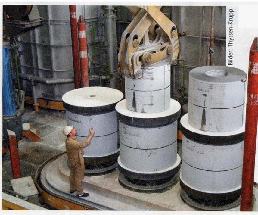
Vorbereitung von Elektroband-Coils für das Hochglühen. Während der Behandlung kommt es zum orientierten Kornwachstum, d.h. zur Ausbildung einer Textur.
