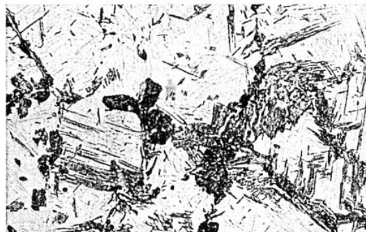
Bild 29. Umwandlung bei kontinuierlicher Abkühlung im Bereich der kritischen Abkühlungsgeschwindigkeit
