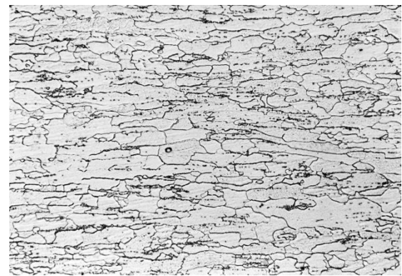
Voll rekristallisiert T = 600 °C, t = 3,3 h
