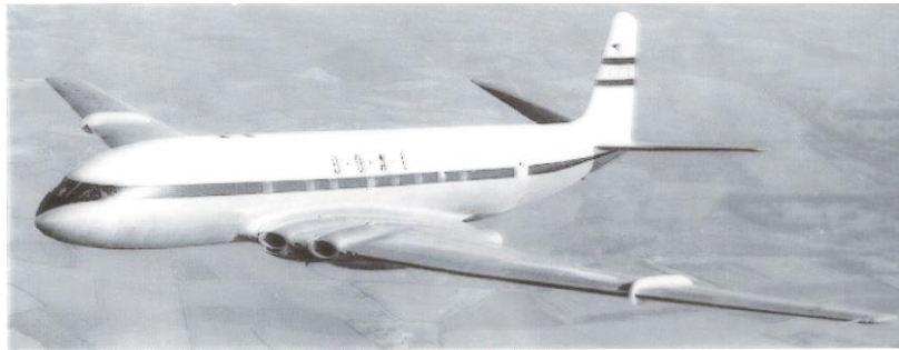
Abb. 5: Die „Comet“ war das erste Passagierflugzeug, das mit Strahltriebwerken betrieben wurde. (England)
