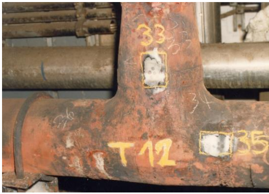
Abb. 150: Replica-Technik in der Praxis (im Kraftwerk):
