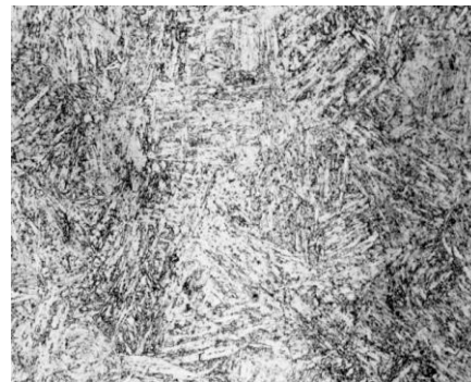
Abb. 152: Nach 72000 Betriebsstunden: grobnadeliger Martensit + Karbidausscheidungen
