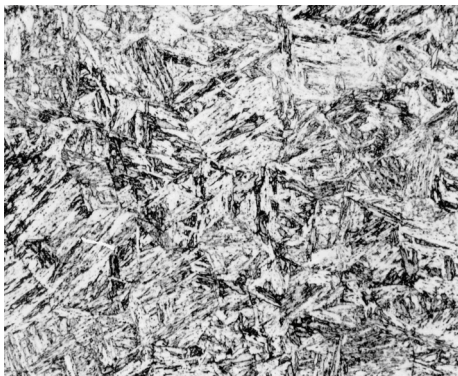
Abb. 151: Korrekte Wärmebehandlung (grobnadeliger Martensit)
